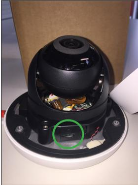
Legen Sie die microSD-Karte in den Slot an der IP-Kamera ein und starten die Kamera neu.
