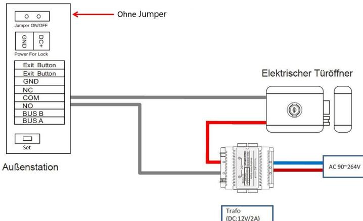
Schließen Sie den Türöffner an die Klemmen NO/COM auf der Rückseite der Außenstation an. Der Türöffner benötigt eine eigene Stromversorgung über einen 12V DC Trafo. Schalten Sie diesen zwischen Türöffner und der Klemme NO. Der Türöffner der Außenstation wird über die Taste
