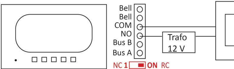
Schließen Sie den Türöffner an die Klemmen NO/COM auf der Rückseite des Monitors an. Der Türöffner benötigt eine eigene Stromversorgung über einen 12V DC Trafo. Schalten Sie diesen zwischen Türöffner und der Klemme NO. Der Türöffner des Monitors wird über die Taste betätigt.
