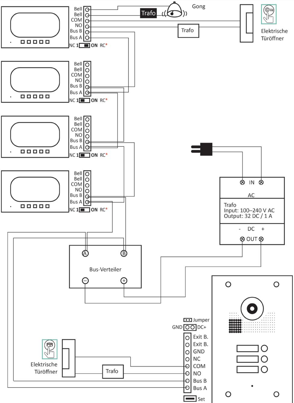
\*Stellen Sie den Schalter bei dem Monitor auf ON, der in der Bus-Verdrahtung am weitesten von der Außenstation entfernt ist. Bei allen anderen Monitoren stellen Sie den Schalter auf 1.
