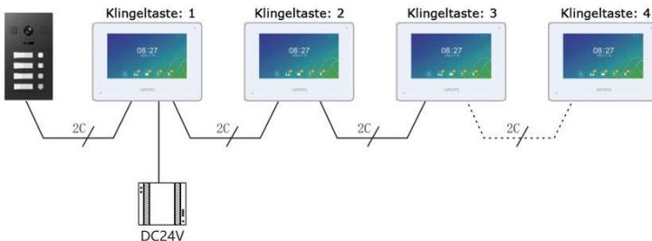
Pro Klingeltaste benötigen Sie einen Monitor, der als Master eingerichtet ist. Wenn mehrere Monitore auf eine Klingeltaste angeschlossen werden, müssen diese als Erweiterung (1/2/3) eingestellt werden. Die Mastermonitore können sich mit dem vorhandenen WLAN verbinden, um die App TuyaSmart für eine Weiterleitung des Klingelsignals zu nutzen.
