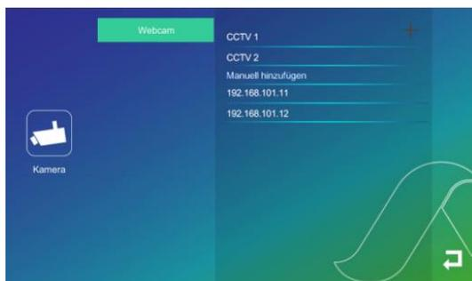
Nach dem Öffnen der Kameraeinstellung, werden alle im Netz verfügbaren IP Kameras angezeigt, wenn alle Parameter übereinstimmen (ONVIF Format, IP Bereich des gleichen Routers). Wählen Sie die IP Adresse der jeweiligen Kamera aus, um sich damit zu verbinden.
