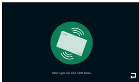
Klicken Sie auf + um neue RFID Karten hinzuzufügen. Das RFID Modul an der Außenstation blinkt und ist für die kommenden 30sek bereit. Halten Sie die gewünschte RFID Karte vor das Lesegerät der Außenstation. Nun erscheint am Monitor die entsprechende Kartenummer und Sie können festlegen, welchen angeschlossenen Öffner die RFID Karte öffnen soll. Setzen Sie hierfür den Haken beim entsprechenden Öffner.
