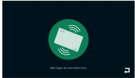
Klicken Sie auf + um neue RFID Karten hinzuzufügen. Das RFID Modul an der Außenstation blinkt und ist für die kommenden 30sek bereit. Halten Sie die gewünschte RFID Karte vor das Lesegerät der Außenstation. Nun erscheint am Monitor die entsprechende Kartennummer und Sie können festlegen, welchen angeschlossenen Öffner die RFID Karte öffnen soll. Setzen Sie hierfür den Haken beim entsprechenden Öffner.
