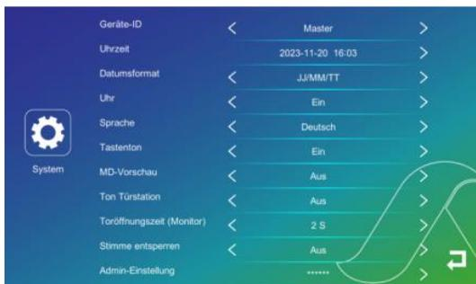
**Geräte-ID:** Hier können Sie zwischen Master/Erweiterungsmonteur auswählen. Als Master wird jeder Monitor benannt, der als Hauptmonitor genutzt wird. Sollten Sie mehrere Monitore in einer Wohnung nutzen, so müssen Sie die weiteren Monitore als Erweiterung1/Erweiterung2 etc. markieren. Beim Mehrfamilienhaus ist jeder Hauptmonitor der Master – nur wenn Sie mehrere Monitore in einer Wohnung nutzen, muss die Einstellung getätigt werden.
